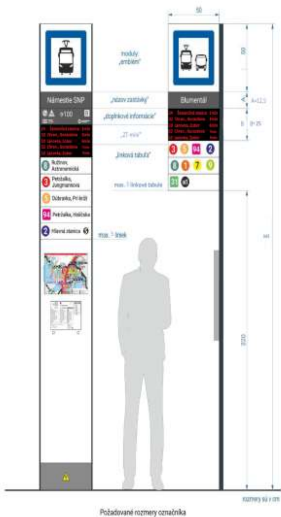
Obrázky: Príklad rozmiestnenia modulov a rozmerov. (Zdroj: Technické a prevádzkové štandardy IDS BK)
