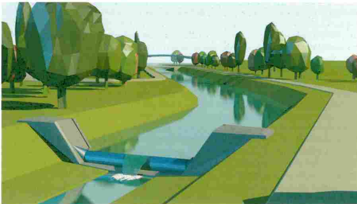
Obr. 24 Vaková haň umiestnená v relat. staničení 2,754 km s prepadajúcim lúčom vody (pohľad proti prúdu)
