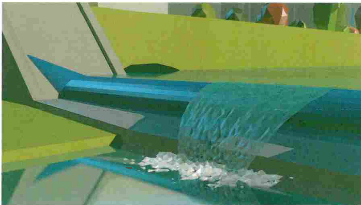
Obr. 32 Detail vakovej hate umiestnenej v relat. staničení 1,433 km
