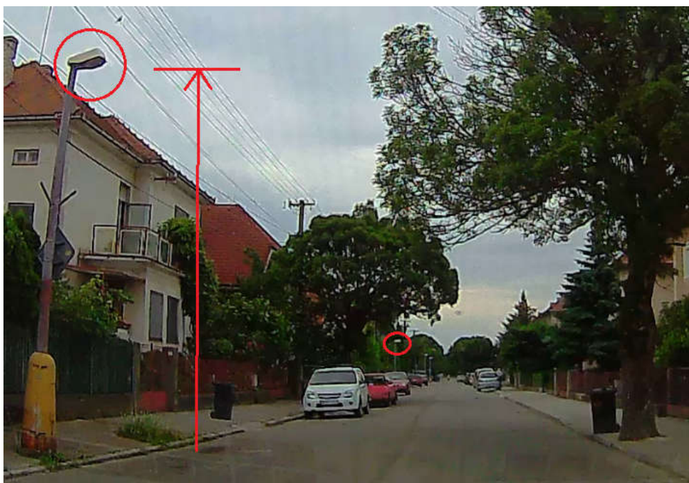
Obr. 17 Veľké rozostupy medzi svietidlami, zlá geometria sústavy, nerovnomernosť osvetlenia, vzdialenosť okolo 40 m medzi stožiarmi, svietidlá na nízkych skorodovaných stožiaroch
